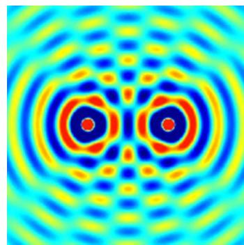
$2y_0 \cos\left(k\frac{\Delta l}{2}\right)$ ,  $\Delta l$ 为P点到两点源的距离差,它随着P点的不同而不同。也就是说在空间各个点,它的振幅是不一样的。空间的距离差是波长的整数倍的时候,正好是两个波等相位叠加。其振幅为 $2y_0$ ;而如果距离差是波长的整数倍再加上半个波长,则正好是两个波反相位叠加,其振幅为零。前者称为相长干涉,后者为相减干涉。因此对于两点源的情况,会看到空间中各点有稳定的振动模式。右图为某个时刻两点源的干涉图,黄色和蓝色是振幅最大的地方,绿色是不动的地方。对于振幅加倍的点,其能量是原来的四倍,而对于振幅为零的点,其能量为零。因此在干涉的过程中能量在空间里进行了重新分配。
